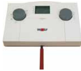
demontáž ART zo sokla pomocou skrutkovača
