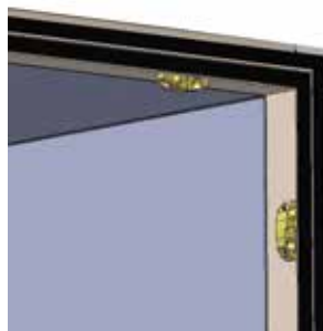
Dichtingsband 6 mm binnen + dichtingsband 3 mm buiten
